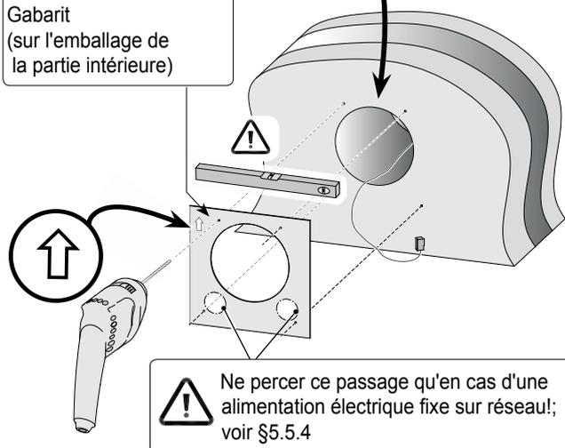
⚠ Ne percer ce passage qu'en cas d'une alimentation électrique fixe sur réseau! voir §5.5.4
