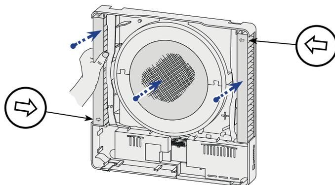
20 Replacer le cache extérieur sur l'appareil.
