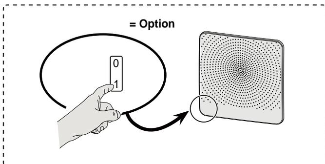
22 Remettre le compteur de filtre à zéro après avoir remplacé/nettoyé les filtres (voir §8.1 point 7).
