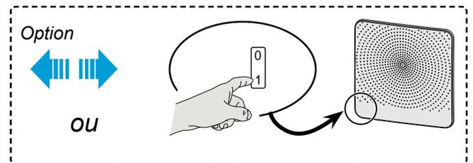
Mise hors tension de l'appareil
