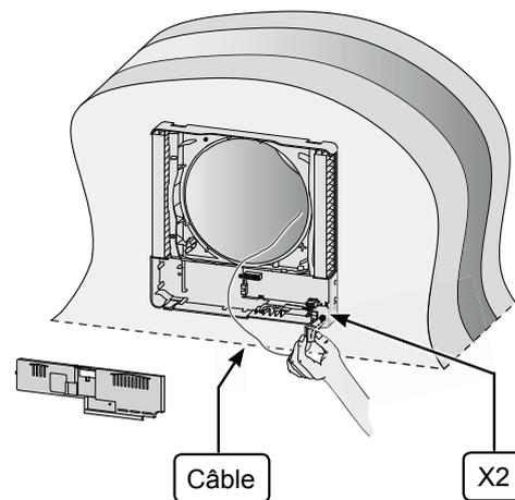
⚠ Veillez à ce que câble de mise à la terre du préchauffeur soit raccordé au connecteur X1 (voir également § 9.1).
