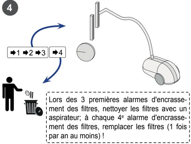
Lors des 3 premières alarmes d'encrassement des filtres, nettoyer les filtres avec un aspirateur; à chaque 4<sup>e</sup> alarme d'encrassement des filtres, remplacer les filtres (1 fois par an au moins) !
