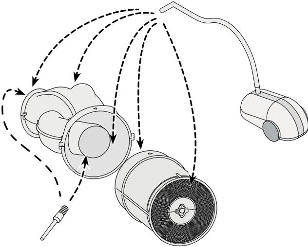
11 Nettoyage si possible l'intérieur de l'échangeur au jet pneumatique basse pression (max. 0,5 bar).
