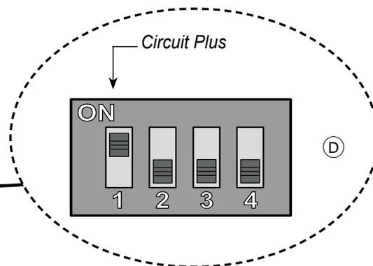
10.2 Raccordement du capteur d'humidité (HR) (uniquement possible avec le circuit Plus)
