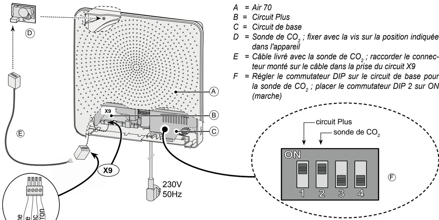
La régulation de CO<sub>2</sub> ne fonctionne que si l'Air 70 est réglé sur la position 1 ou 2. Si la sonde de CO<sub>2</sub> enregistre une augmentation de la valeur de CO<sub>2</sub>, le débit de ventilation est automatiquement augmenté. En cas de diminution de la valeur de CO<sub>2</sub>, le débit de ventilation est automatiquement diminué (voir illustrations).
