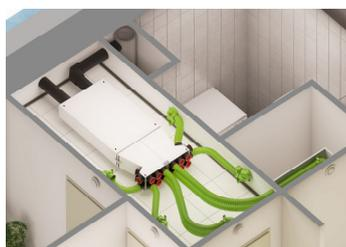
Les Renovent Sky 150, 200 et 300 peuvent être équipées d'un caisson de distribution d'air intégré insonorisé ce qui permet une installation compacte du système.
