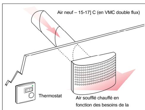
Une maison passive nécessite un système de chauffage adapté. Les technologies de construction de maisons passives réduisent les besoins en chauffage et en refroidissement.
