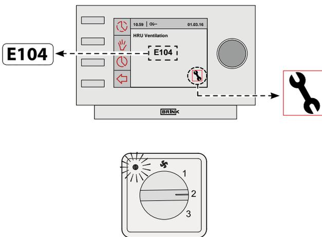
Lorsque l'appareil signale un dérangement verrouillant, l'appareil ne fonctionnera plus. Le symbole de dérangement (clé plate) s'affichera à l'écran (de façon permanente) en même temps que le code de dérangement. La lampe rouge du
