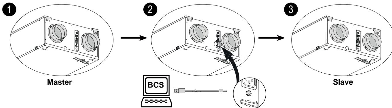
Les appareils esclaves doivent être réglés comme esclaves avant que les appareils ne soient reliés ensemble par l'eBus! Voir pour de plus amples instructions le manuel outil-entretien fourni avec l'appareil! Chaque appareil doit disposer d'une prise murale 230 volt distincte.
