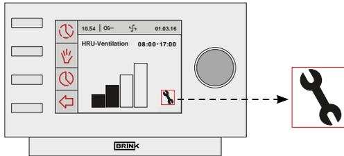
Lorsque l'appareil signale un dérangement non verrouillant, l'appareil continuera de fonctionner (de façon limitée). L'écran affiche alors le symbole de dérangement (clé plate). La nature de ce dérangement peut être affichée dans le menu « Messages ».
