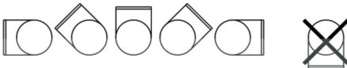
Les ouvertures doivent être équipées de grilles solidement fixées ou de bouches d'air d'admission pour empêcher tout contact avec l'élément de chauffe. Une notice sera placée à proximité des bouches de soufflage d'air, indiquant que le recouvrement de celles-ci est dangereux.
