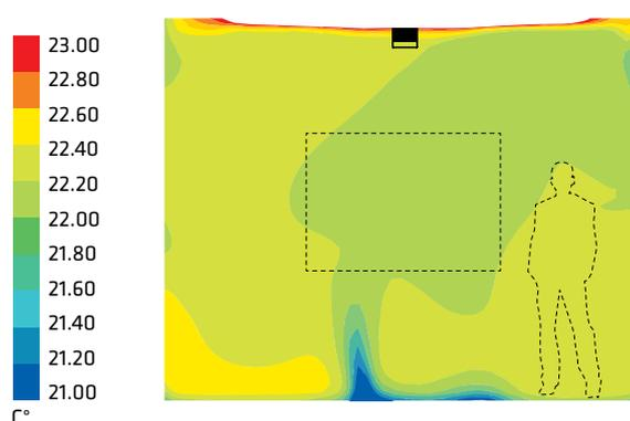
On peut observer sur le graphique ci-dessus que, dans les maisons passives dotées de bouches soufflantes de chauffage ECO, la distribution de la température dans l'ensemble d'une pièce est très régulière. La zone de refroidissement qui apparaît au centre du graphique est provoquée par l'air froid pénétrant à travers la fenêtre.
