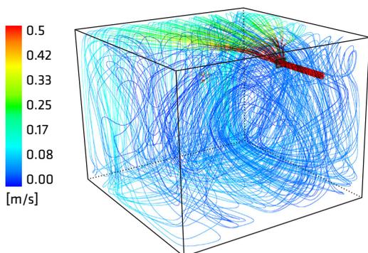
Les bouches de soufflage ECO garantissent une distribution d'air régulière et dépourvue de courants d'air dans toute la pièce grâce à leurs rapports élevés de mixage du flux d'air.
