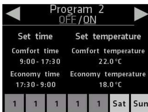
11. Vous pouvez configurer jusqu'à 7 programmes différents avec des temps de confort et des températures différentes.
