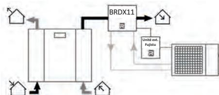
Cette batterie est un échangeur isolé à détente directe destiné au rafraîchissement dans un système de ventilation double flux. Elle doit être associée à une unité extérieure de climatisation split de puissance adaptée (2,5 kW – 3,5 kW) et à un système de contrôle intelligent garantissant un fonctionnement fiable et performant. Il est nécessaire de calorifuger les gaines de ventilation et les caissons de distribution afin d'éviter la formation de condensation.
