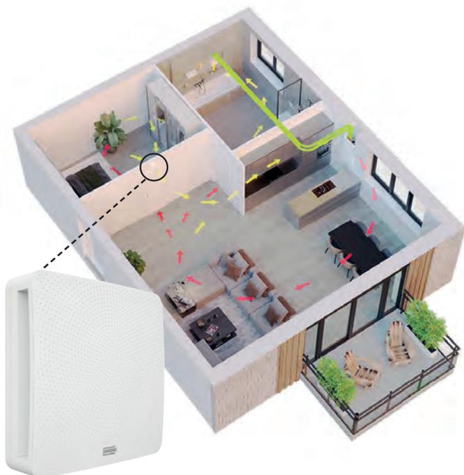
Appartement de 2 pièces avec Ease 100 comme ventilation **semi-centralisée** (encastré dans le mur) avec un ventilateur **Multi Air** Indoor Mixfan.
