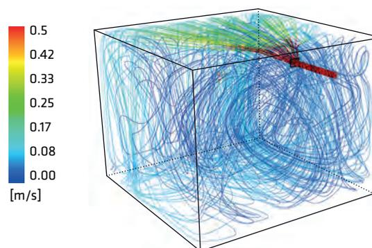
Les bouches de soufflage ECO garantissent une distribution d'air régulière et dépourvue de courants d'air dans toute la pièce grâce à leurs rapports élevés de mixage du flux d'air.
