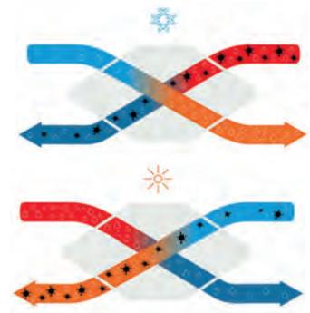
L'échangeur enthalpique offre un rendement de la température\*, mais aussi un rendement enthalpique\*\*, c'est-à-dire un rendement par transfert de l'humidité. Le rendement total de l'énergie offert par l'échangeur enthalpique est alors supérieur à 136%. Le rendement du récupérateur de chaleur\* d'un échangeur enthalpique est légèrement inférieur à la récupération de chaleur d'un échangeur standard.
