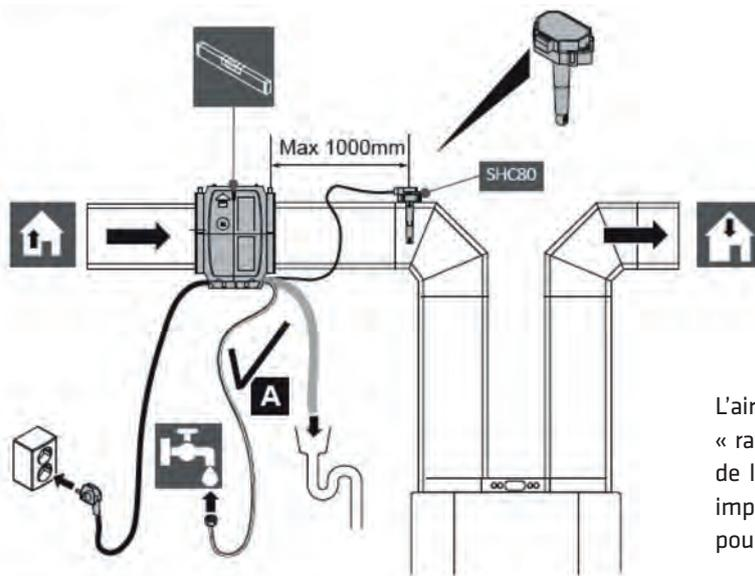
L'air neuf extérieur chaud passe dans l'échangeur de « rafraîchissement ». Il est soufflé (sans élévation de l'humidité) et refroidi dans le logement. Il est important d'avoir un renouvellement d'air suffisant pour optimiser le rendement de l'installation.
