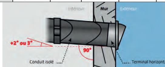
Lors de l'installation, prévoyez une légère pente afin de permettre l'écoulement vers l'extérieur d'éventuelles infiltrations de pluie dans le conduit.
