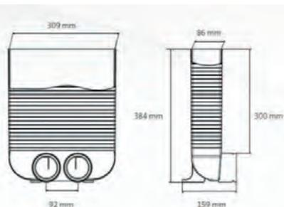
Té de raccordement 2 piquages livré avec un bouchon de gaine et un bouchon de travaux.
