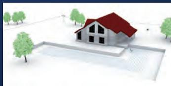
Surface de captage : 150 % à 200 % de la surface à chauffer
