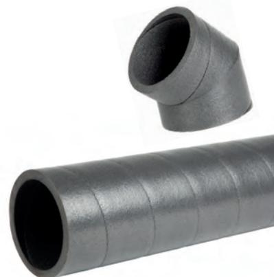
Kit de distribution d'air isolé en EPE (Polyéthylène expansé) dédié au raccordement d'une centrale de VMC double flux vers l'extérieur (façade ou toiture). La centrale de ventilation est raccordée aux caissons de distribution d'air via des silencieux et des conduits isolés. Isole parfaitement sur une plage de température comprise entre -30°C et +60°C. Adapté pour l'air neuf et vicié. En neuf et rénovation.
