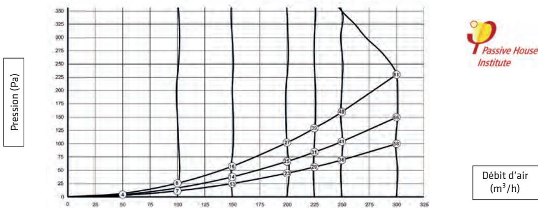
Valeur dans les cercles = [Puissance absorbée par ventilateur en Watts]
