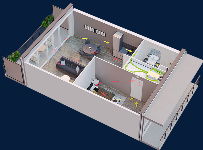
Appartement de 2 pièces équipé d'un Ease 100 modèle centralisé (au plafond, dans l'entrée)
