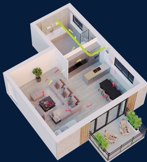
Logement étudiant avec Ease 100 comme ventilation semi-centralisée (encastré dans le mur)
